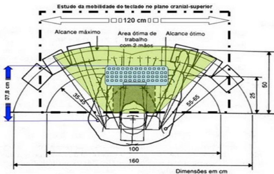
Figura 16: Dimensões da área de operação de um operador de check-out [12]
