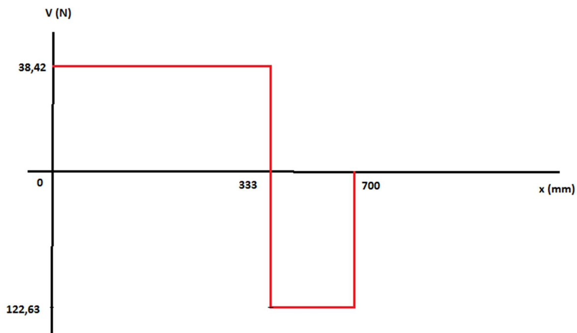
Figura 23: Diagrama do esforço cortante no plano vertical
